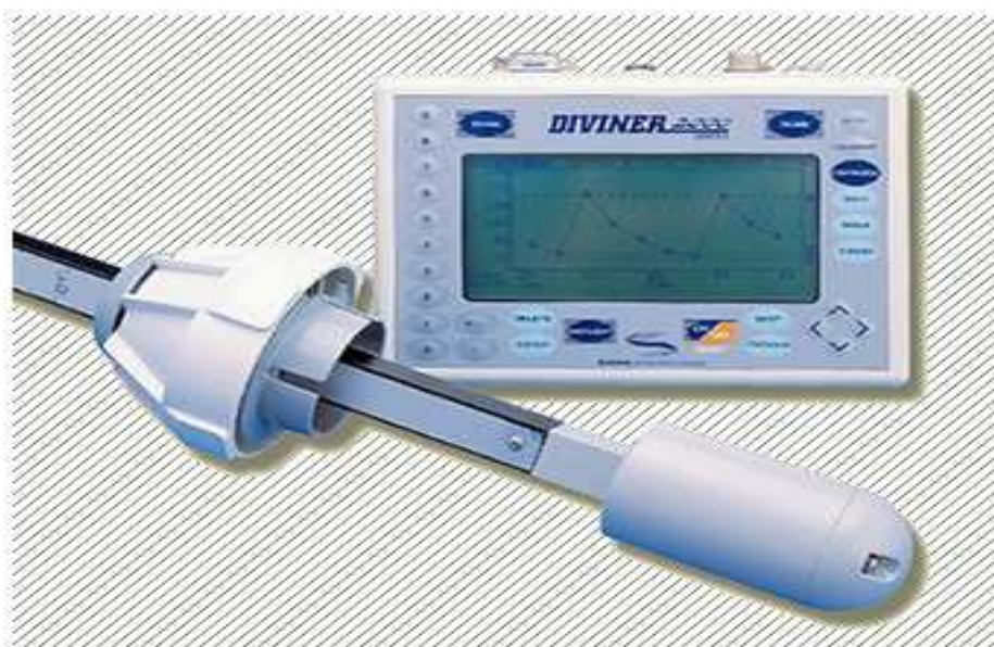
Fig.9 DIVINER 2000. Equipo portátil para monitoreo de humedad de suelos
