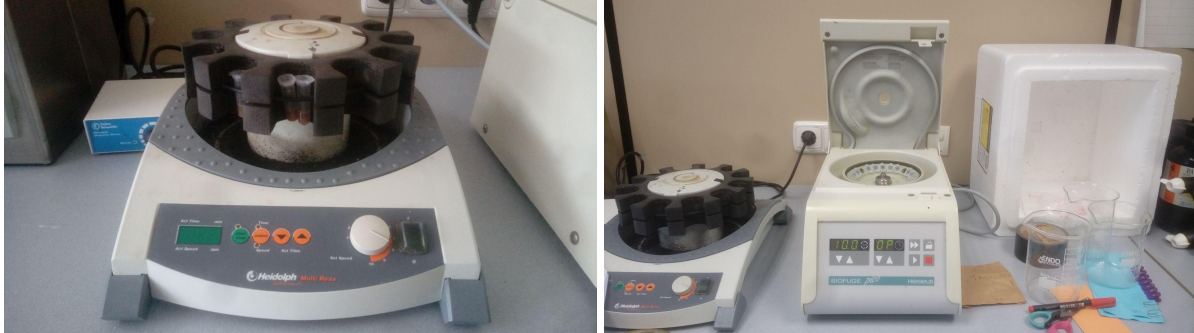
Figura 2. Agitador y centrifugadora empleados en la extracción de \text{H}_2\text{O}_2 de las muestras de raíz.
