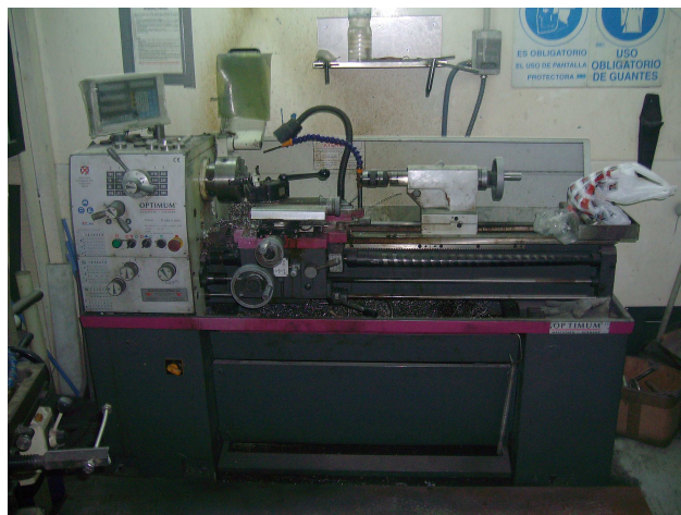
Figura 3: Torno con nonius digital.
