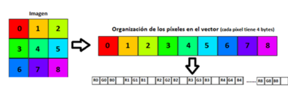
Figura 3.8 Disposición de los píxeles RGB en el array de bytes
