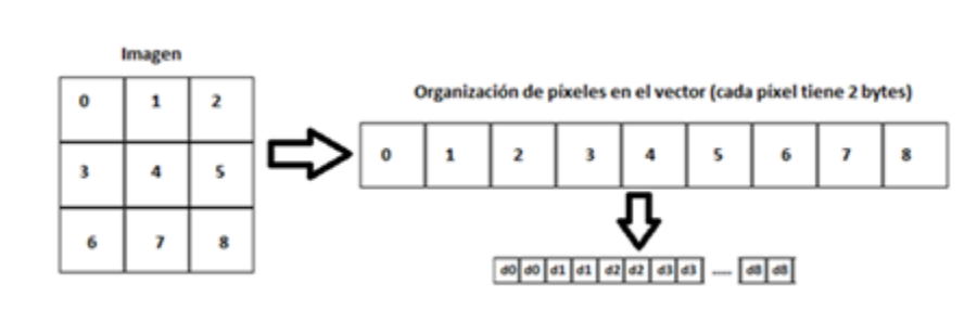
Figura 3.10 Disposición de los píxeles de profundidad en el array de bytes
