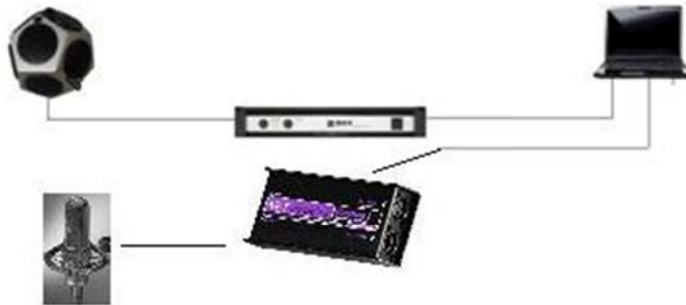
Figura 3.2 Esquema de conexión para medición de eficiencia lateral
