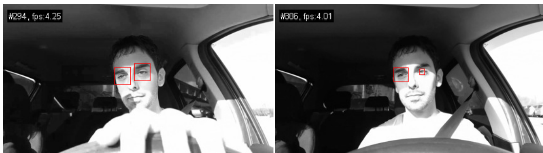
Figura 13.7 – Ejemplo de detección correcta (izquierda) y reducción del tamaño de bounding box (derecha)
