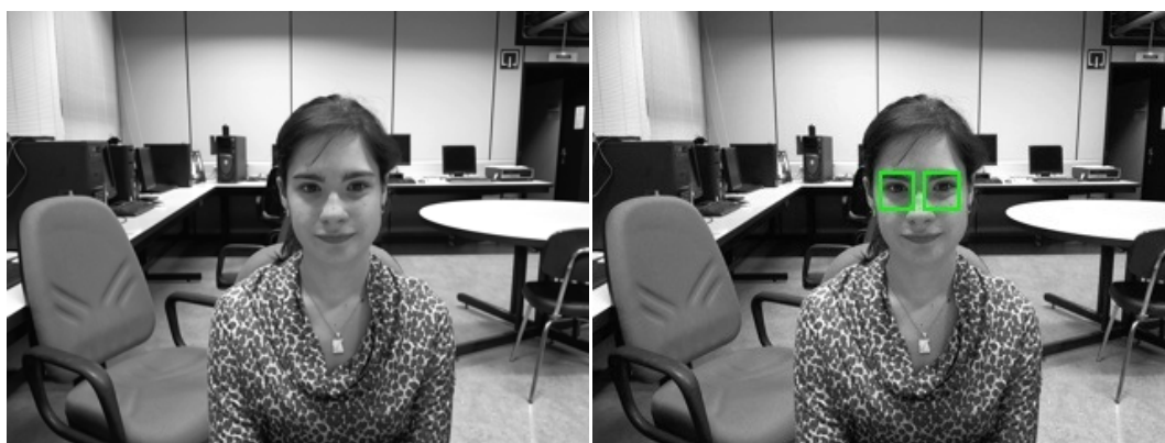
Figura 2.1 – Ejemplo de imagen a procesar (izquierda) y objetivo de la detección (derecha)
