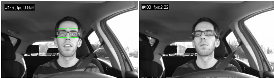
Figura 13.11 – Ejemplo de detección correcta (izquierda) y no detección debida al parpadeo (derecha)
