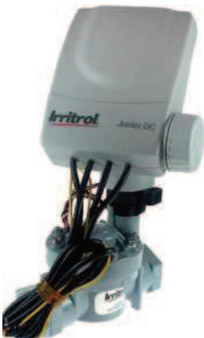
Cables de automatización: Estos cables se encargan de transferir las órdenes del programador a las electroválvulas. Se dispondrá de un solo cable llamado común que recorrerá todas las electroválvulas de un mismo sector. Por cada sector se instalará un cable que se conectará en el número de programa que corresponda.
