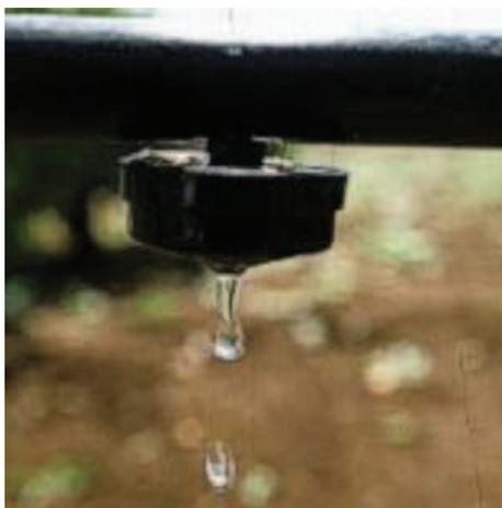
Fotografía 8.6. Gotero pinchado en el tubo de 16mm
