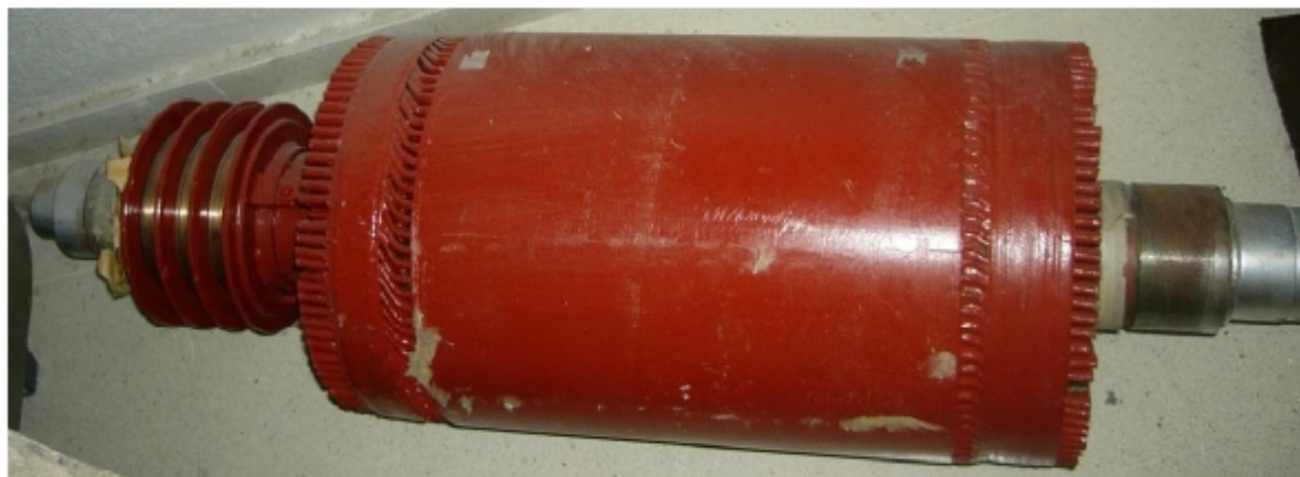
Rotor bobinado y anillos rozantes.
