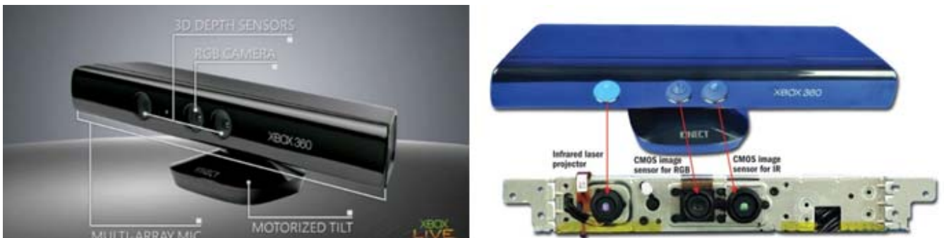
Figura 2.1.1: Partes del sistema Kinect
