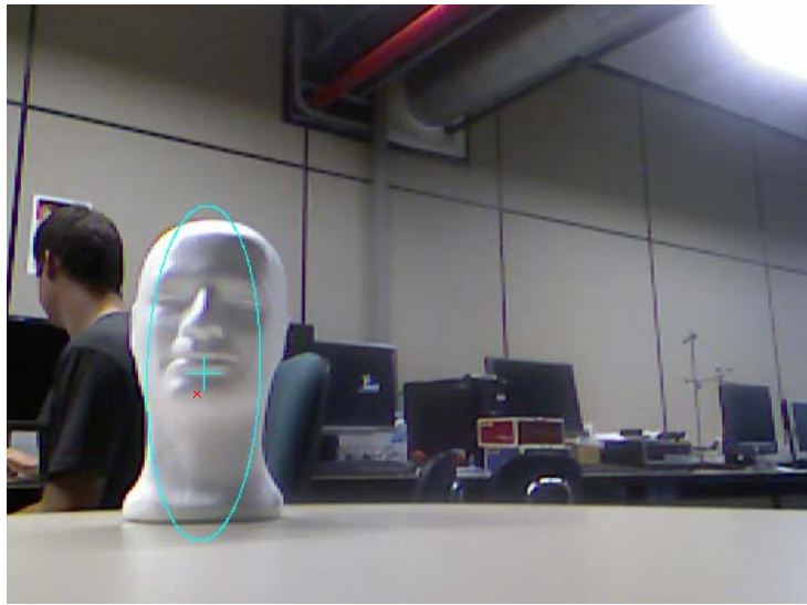
Figura 4.3.4: Ejemplo de mala detección de la nariz y elipse estando la Kinect por debajo de los ojos (Kinect y cabeza encima de la mesa)
