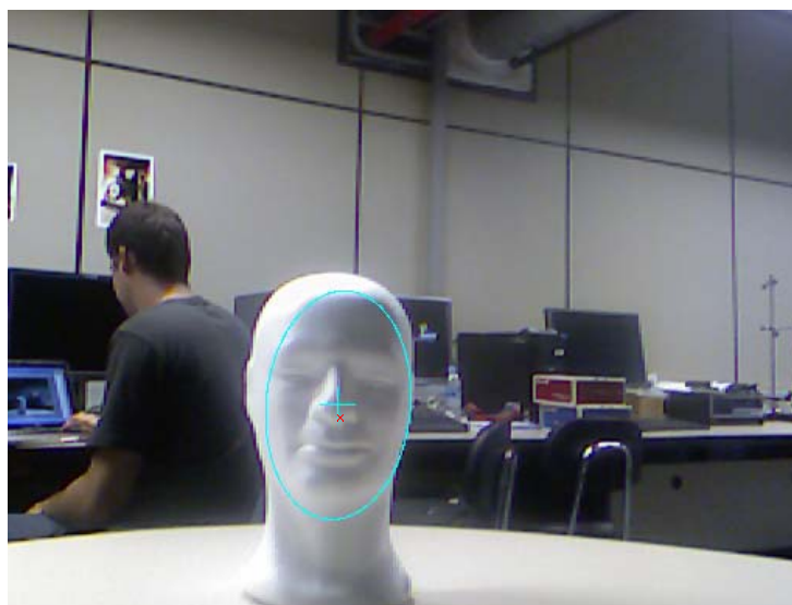
Figura 4.3.5: Ejemplo de buena detección de la nariz y elipse estando la Kinect por encima de los ojos (Kinect elevada y cabeza en la mesa)
