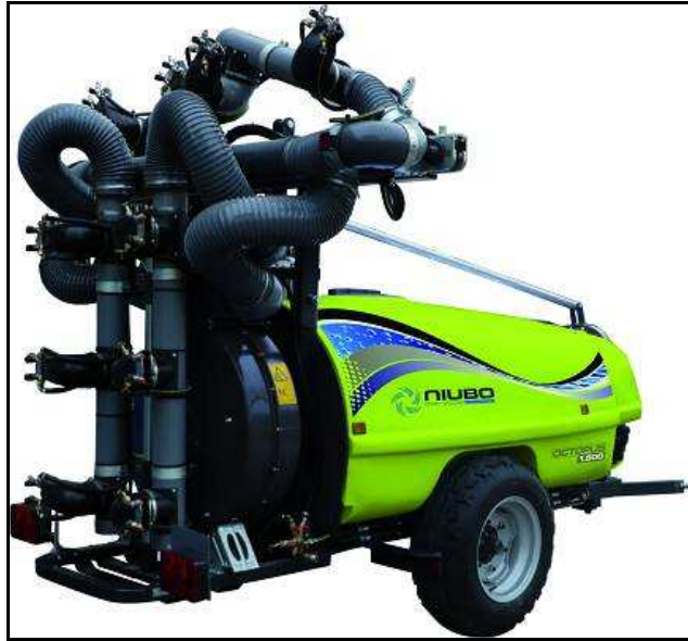
Figura 6. Equipo pulverizador neumático (Modelo Niubo Octopus, http://www.niubo.info/ ).
