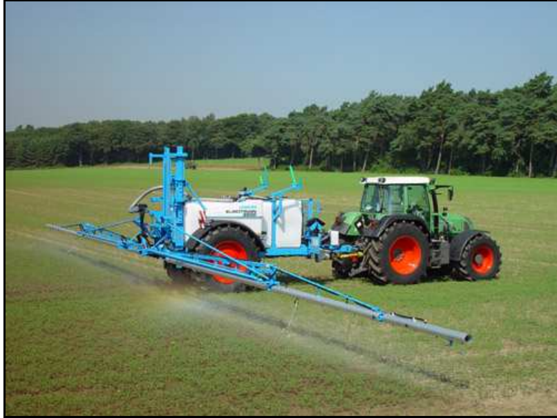
Figura 4. Equipo pulverizador hidráulico en plena acción de aplicación de fitosanitarios sobre un cultivo (Modelo EUROTRAIN, http://uk.lemken.com/en/home/ ).
