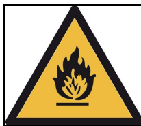
Figura 21. Pictograma indicativo de riesgo de incendio.
