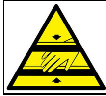
Figura 37. Pictograma indicativo de riesgo por atrapamiento por el agitador mecánico del depósito en los elementos genéricos de los espolvoreadores.
