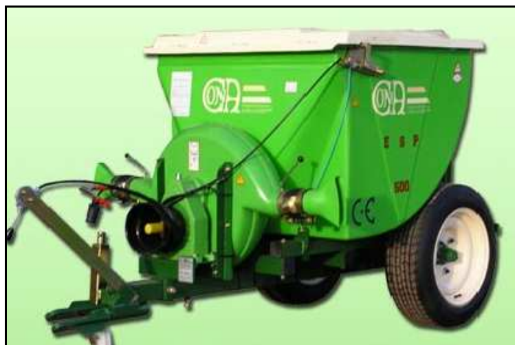
Figura 8. Espolvoreador arrastrado (Modelo 500 kg, casa http://www.general-agricola.es/ ).
