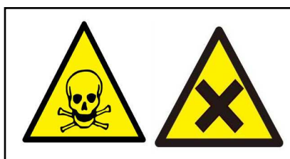
Figura 30. Pictograma indicativo de riesgo por exposición a productos químicos peligrosos en los elementos genéricos de los pulverizadores hidráulicos.
