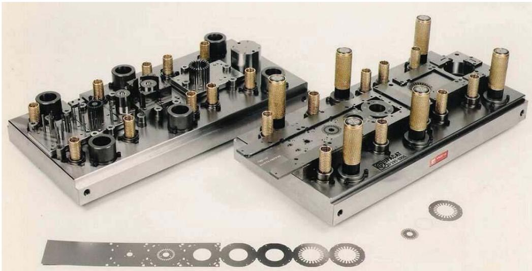
Figura 3.3. Ejemplo de utillaje progresivo y el progreso de la banda de chapa.
