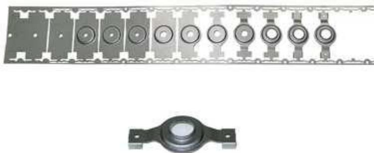
Figura 3.4 Ejemplo de banda de troquel en alimentación semiautomática. Obsérvese el principio y fin de la banda de chapa.
