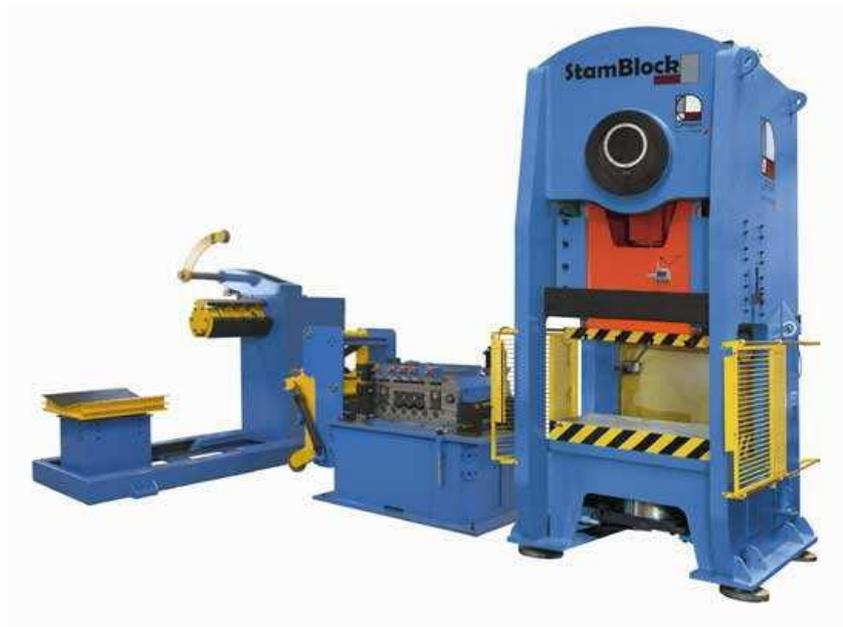
Figura 3.5. Línea automática de producción equipada con: Devanadora, Enderezador de banda, Alimentador y Prensa.
