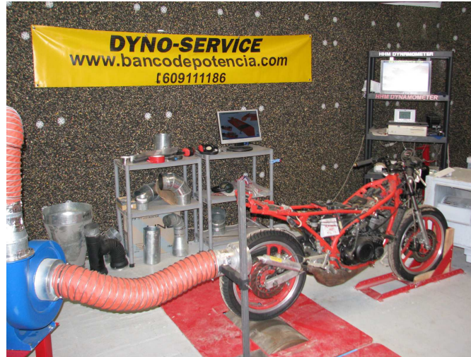
Banco de potencia en foso
