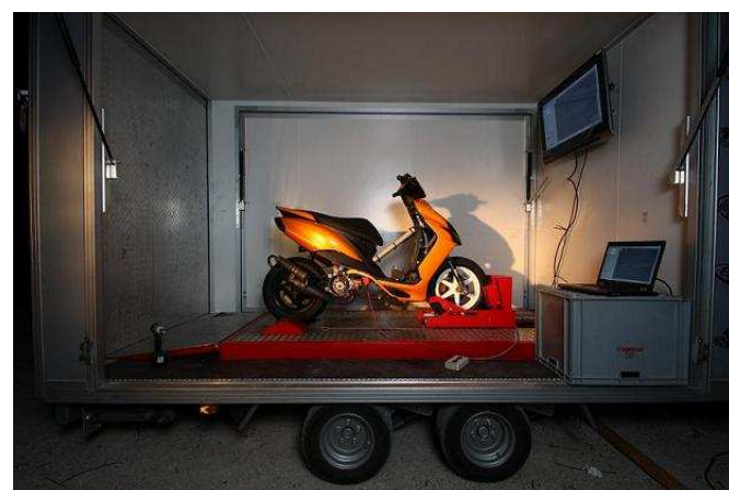
Banco de potencia móvil en remolque
