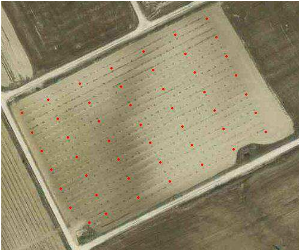
Figura 25. Puntos de muestreo de resistencia a la penetración
