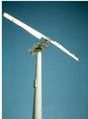
Imagen 2.13: Hélice bipala. Fuente: Energía eólica, Pedro Fernández Díez
