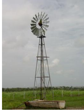
Imagen 2.15: Hélice multipala. Fuente: Energía eólica, Pedro Fernández diez
