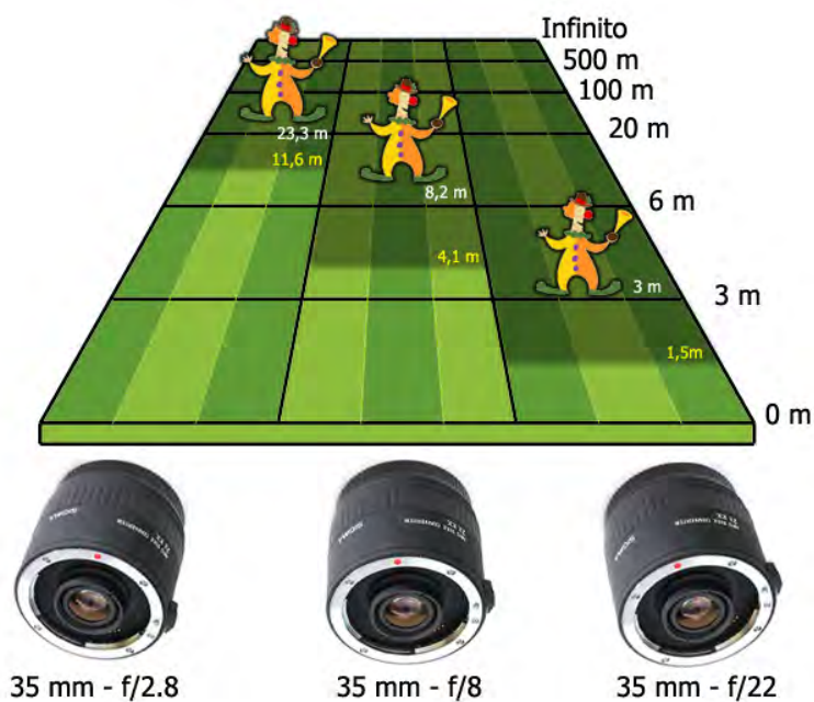
Disminución de la distancia hiperfocal según va disminuyendo la apertura del diafragma.
