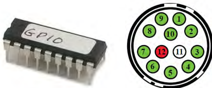
Pin genérico de propósito general entrada/salida y su conector de 12 pines.
