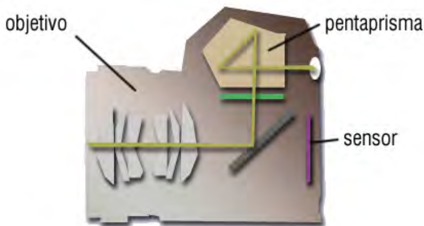
El conjunto de espejos y el sensor.
