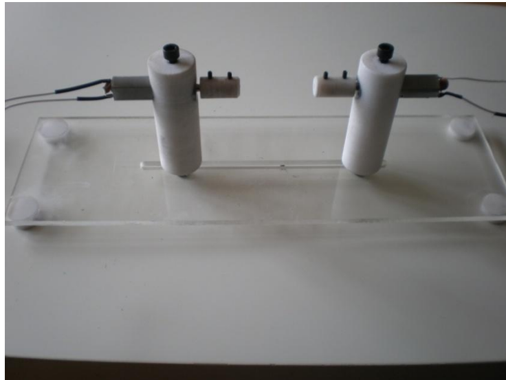
Figura 35 Dispositivo para rotación de la fibra óptica.
