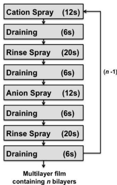
Figura 14 Esquema del autoensamblado LbL -spray donde “n” es el número de bilayers[25]
