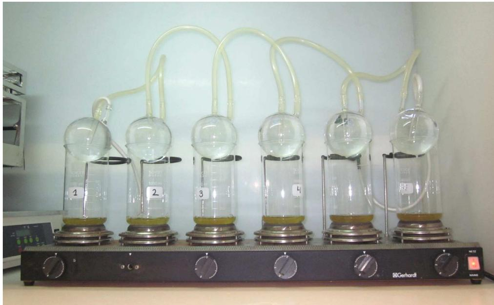
Figura 8: montaje para la digestión de los extractos
