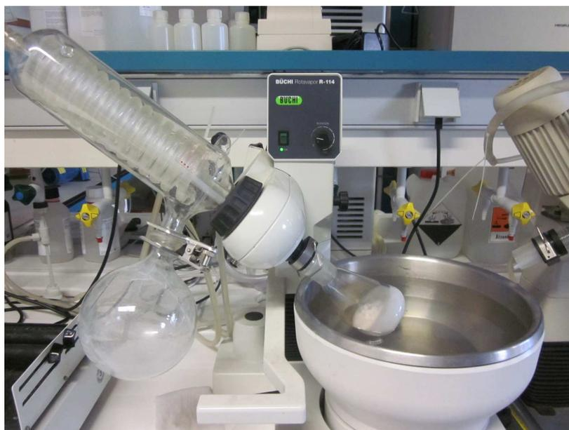
Figura 11: Evaporación del disolvente de la muestra en el rotavapor
