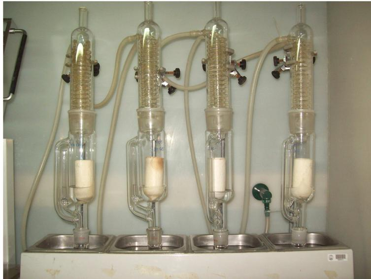
Figura 7: Sistema para la extracción de la grasa total
