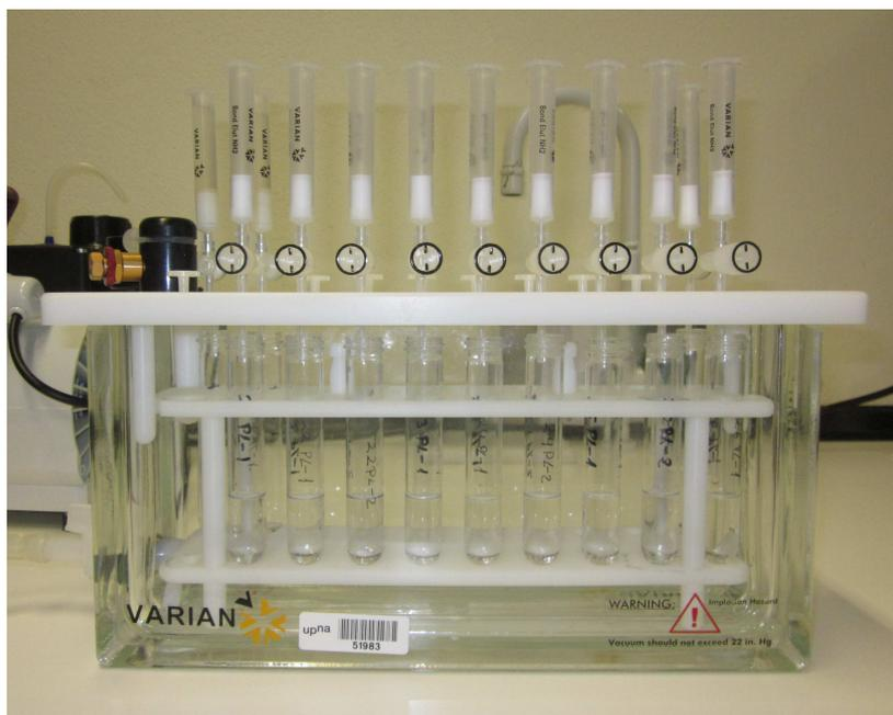
Figura 12: Separación de las fracciones lipídicas a través de cartuchos de extracción
