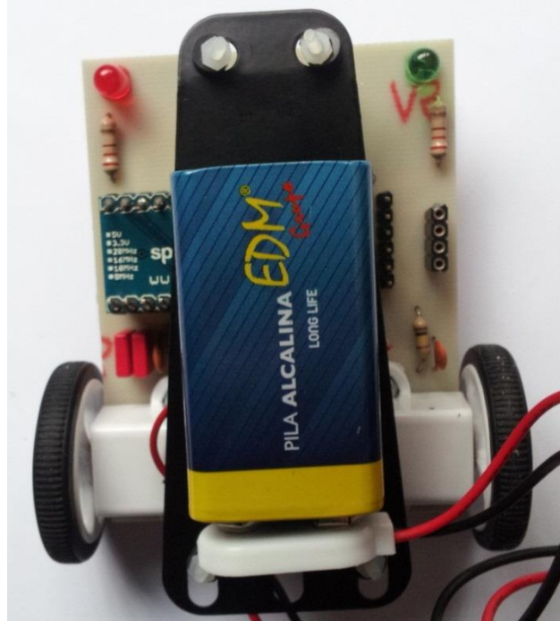
Figura 5-7: Colocación de soporte para pila y pila
