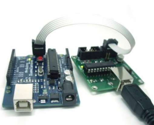
Figura 3-3: Programación de un Arduino UNO a través de otro dispositivo
