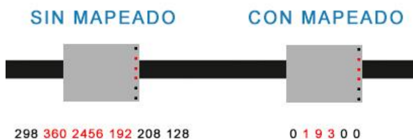
Figura 7-3: Diferencia entre los valores devueltos por los sensores infrarrojos con y sin mapear
