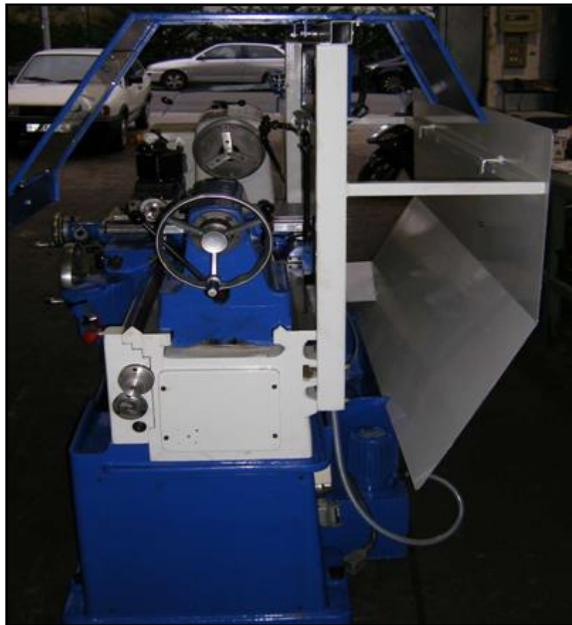
Ejemplo del montaje de un resguardo fijo que protege la parte trasera del torno
