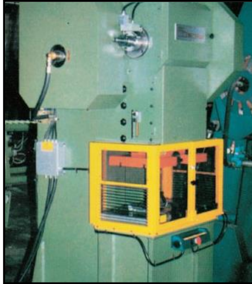
Ejemplo montaje del resguardo móvil con dispositivo de enclavamiento y bloqueo en Prensa Hidráulica
