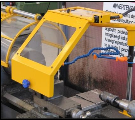
Resguardo móvil del carro de herramienta
