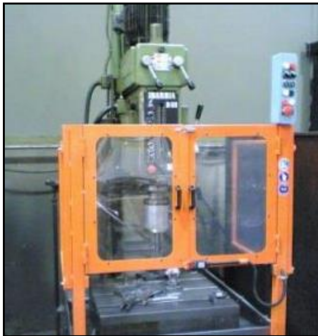
Ejemplo del montaje de un resguardo móvil regulable
