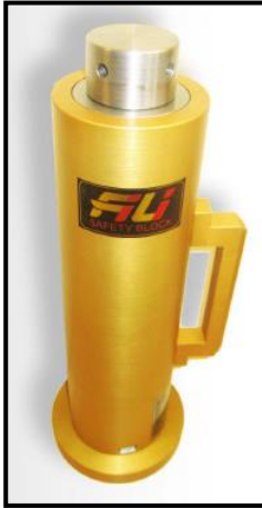
Útil de bloqueo mecánico del troquel
