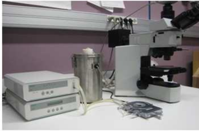
Figura 2.8: Imagen del microscopio óptico, vaso Dewar, equipo de calentamiento y enfriamiento y pletina.
