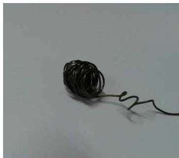
Figura 2.6: Alambre de Kanthal en el que se introducirá la muestra al horno vertical.
