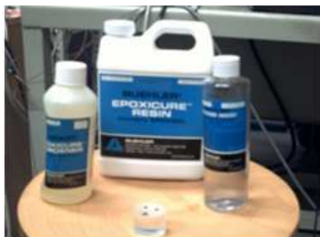
Figura 2.3: Elementos necesarios para en encapsulamiento de la muestra, resina, endurecedor y agente antiadherente para la extracción de la cápsula del molde.
