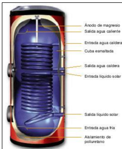
Ilustración 30. Acumulador e intercambiador interior de serpentín
