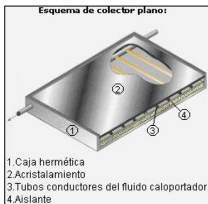
Ilustración 24. Componentes de un colector plano
