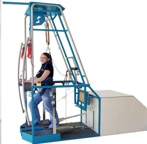
Fig.2 y 3: GT (asistencia robótica.)
