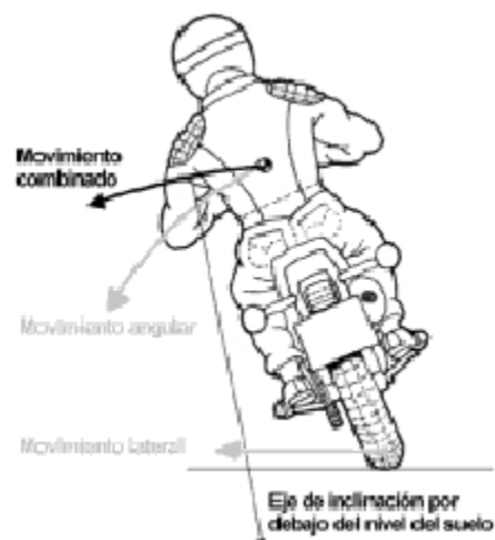
Fig. 5.30 Al añadir los dos movimientos se produce un movimiento combinado con un radio más grande.
