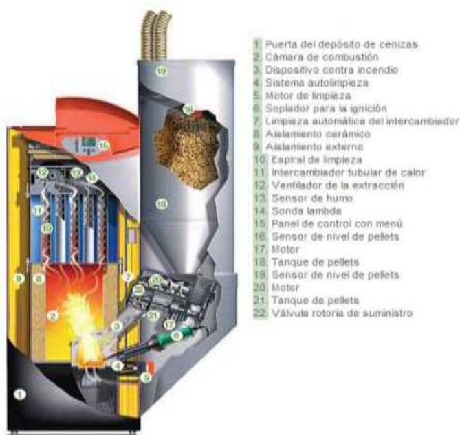
Figura 23: caldera de pellets con depósito instalado.
