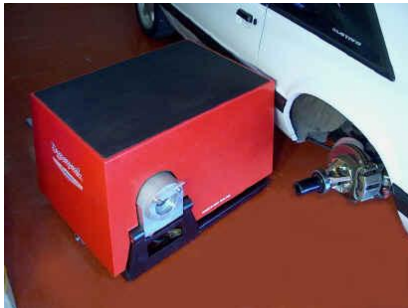
Figura 1.2. 5: Dinamómetro sin rodillo
