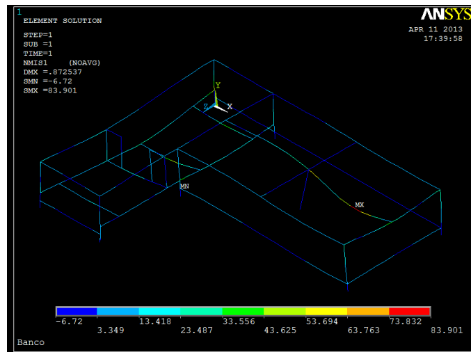
Figura 1.7. 11: Resultados tensión/deformación de la estructura en Ansys
