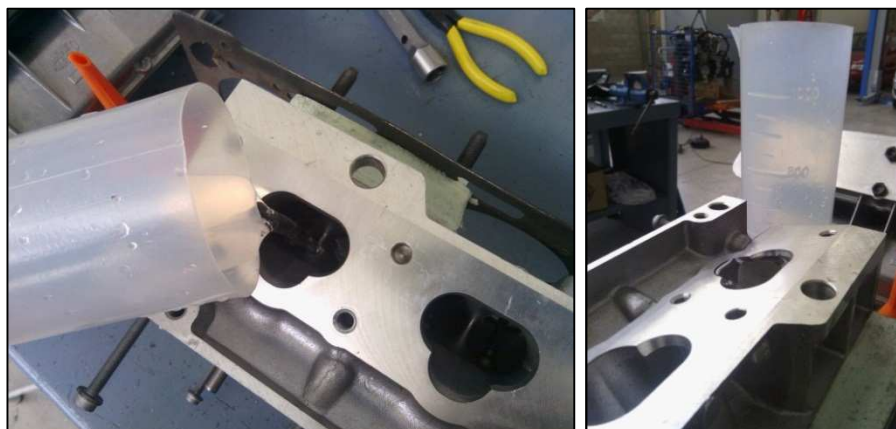
Figura 7.12.- Llenado de la zona de admisión de la culata
