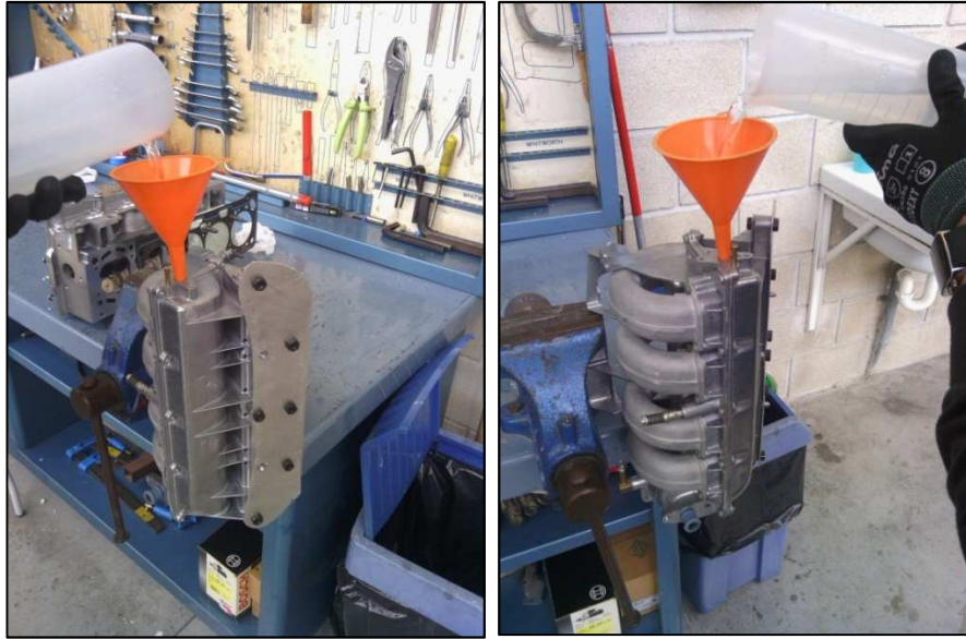
Figura 7.11.- Llenado del colector en posición vertical
