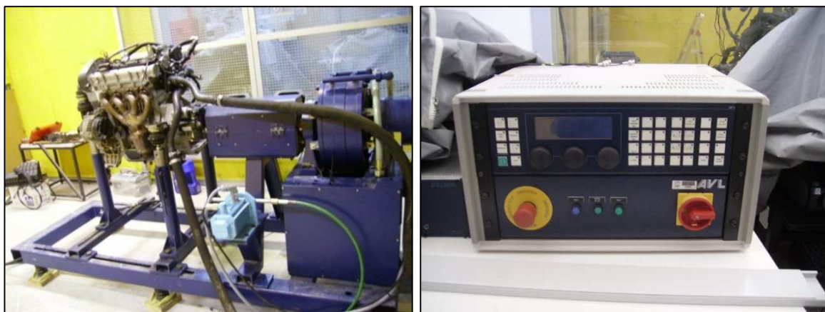
Figura 7.1.- Freno electromagnético y banco de corrientes parásitas utilizados para los ensayos
