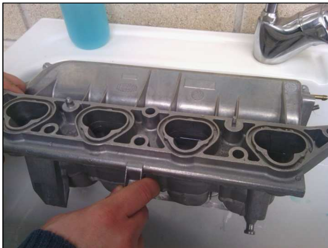
Figura 7.9.- Llenado del colector en posición horizontal
