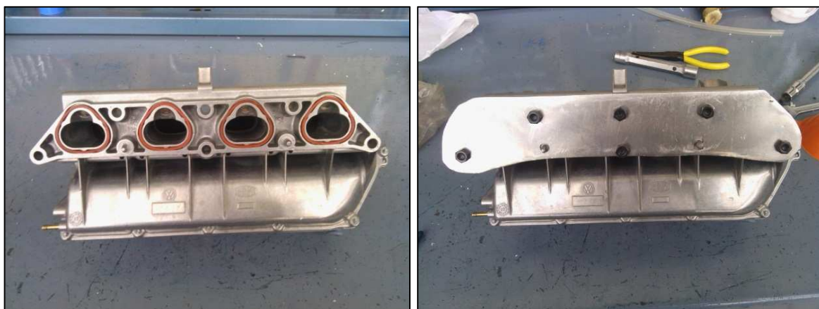
Figura 7.10.- Orificios del colector de admisión con las juntas y tapa fabricada
