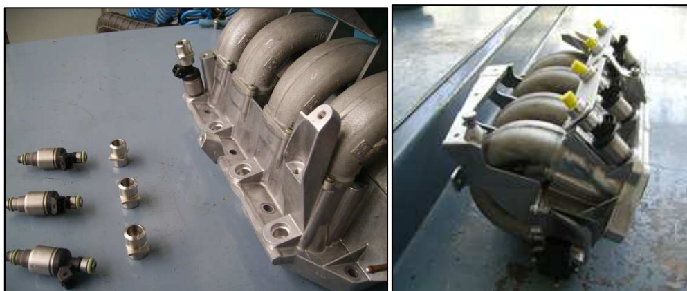
Figura 3.18.- Fotografías de la instalación de los inyectores de gas
