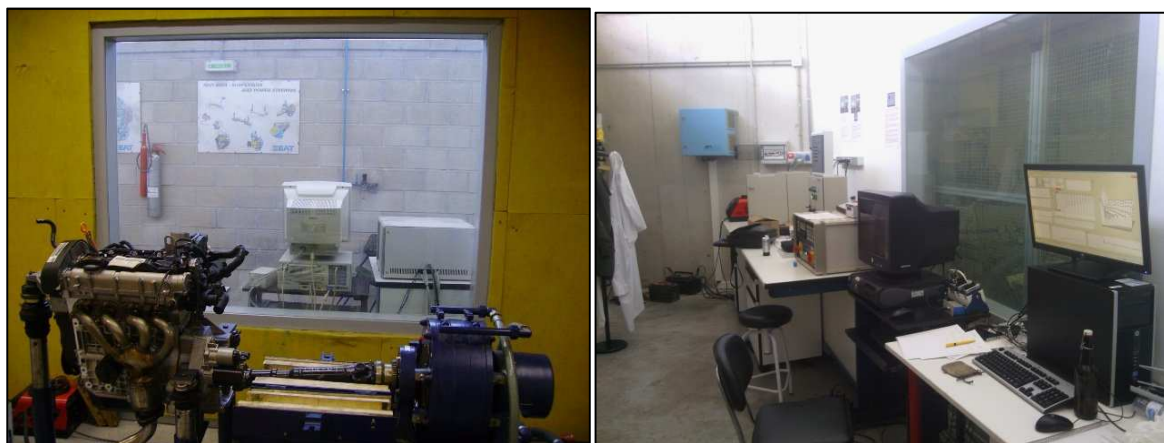
Figura 7.3.- Puesto de control situado fuera de la celda del motor
