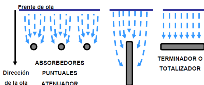
Fig. 2. Clasificación de los sistemas de captación en función de su orientación respecto al oleaje.
