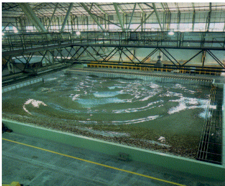
Fig. 133. Ejemplo de tanque de oleaje multidireccional del Centro de Estudios de Puertos y Costas del CEDEX
