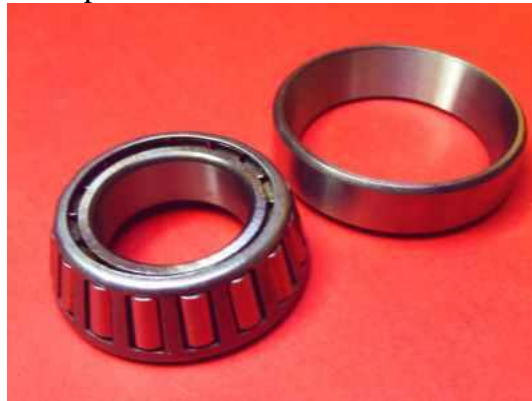
Rodamiento cónico utilizado en la pipa de la dirección
