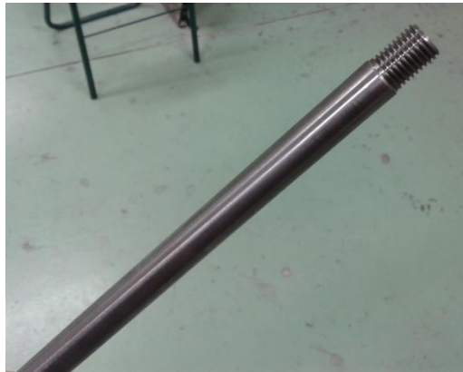
Eje Rueda delantera en acero F125
