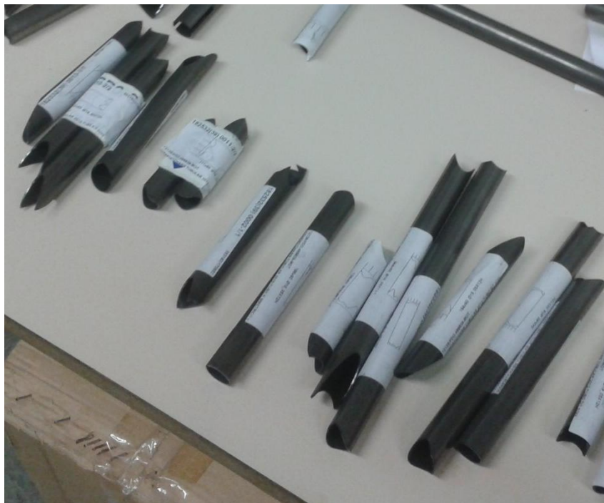
Tubos de diámetro 19mm del chasis después del corte laser
