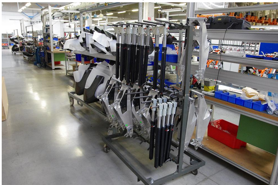
Estantería Tipo 1 donde almacenamos suspensiones delanteras y basculantes
