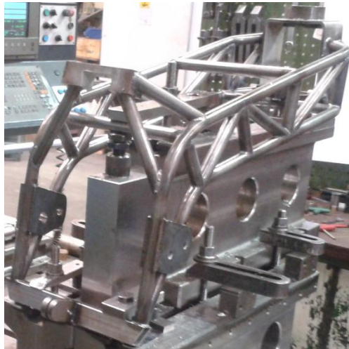
Chasis soldado, a punto de ser mecanizado.
