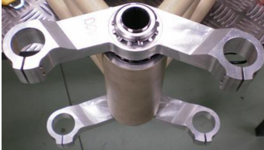
Conjunto tija superior e inferior en montaje sobre el eje de la LMP
