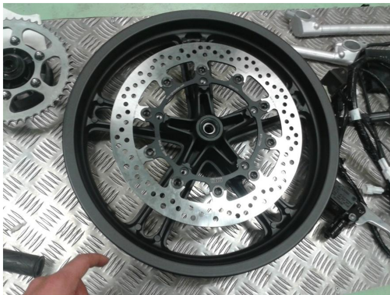
Disco de freno delantero 320mm de NG montado sobre la llanta
