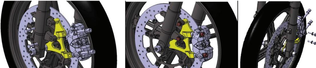
Ilustración 116. Aspecto del diseño en detalle de la unión pinza de freno delantera-horquilla telescópica
