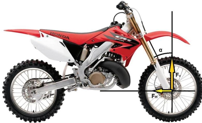
Ilustración 27. Influencia del ángulo de lanzamiento en la descomposición de fuerzas actuantes sobre la horquilla telescópica
