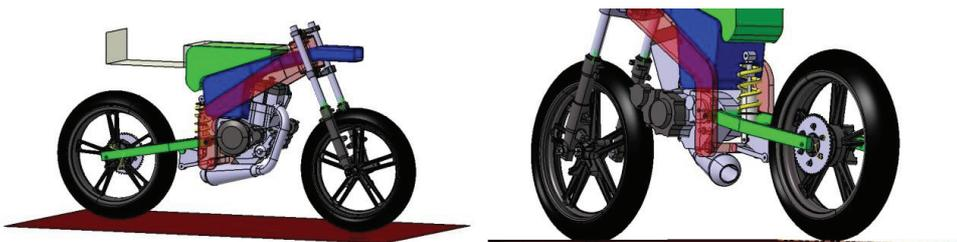
Ilustración 87. Alternativa de escape ruteado bajo el propulsor
