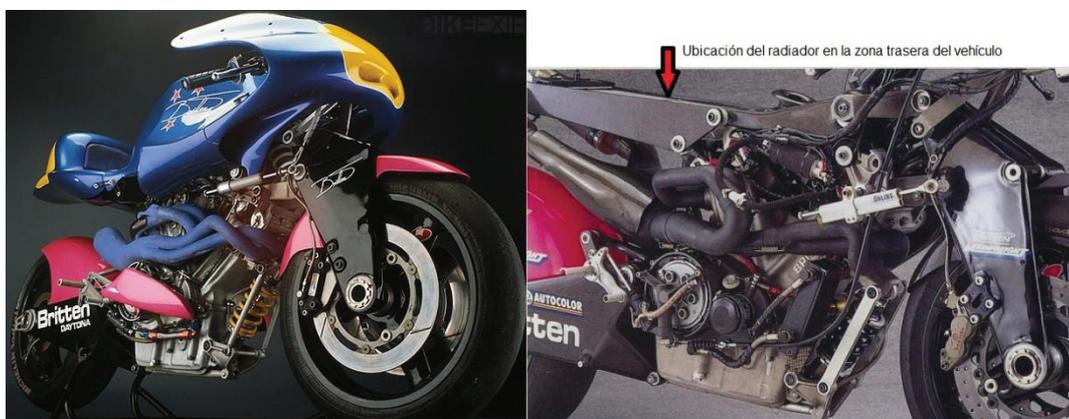
Ilustración 96. Alternativa de posicionamiento del radiador en la parte trasera de la motocicleta
