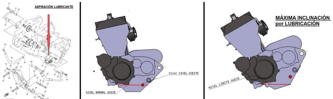
Ilustración 50. Límite al posicionamiento del propulsor debido a la lubricación
