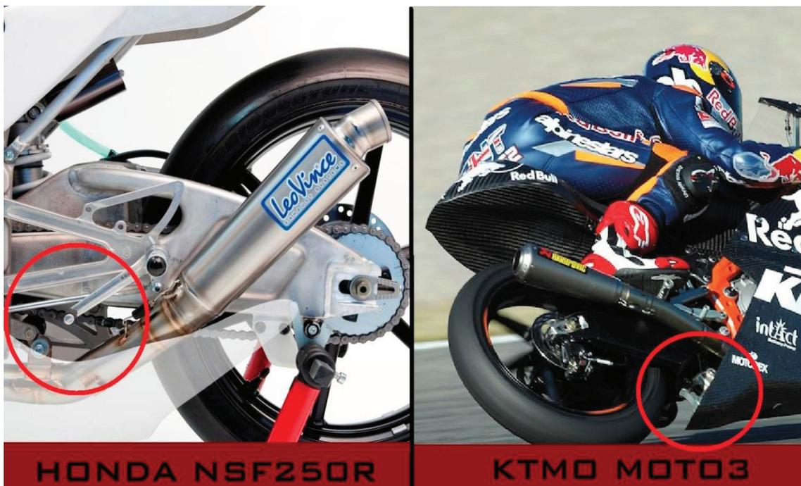
Ilustración 75. Detalle del sistema de bieletas empleado por las motocicletas de referencia
