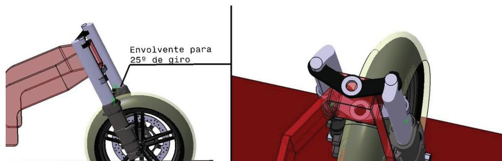
Ilustración 57. Envolvente del espacio libre necesario para un ángulo de giro de  $25^\circ$
