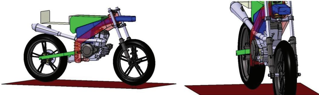
Ilustración 91. Alternativa de escape ruteado sobre el propulsor
