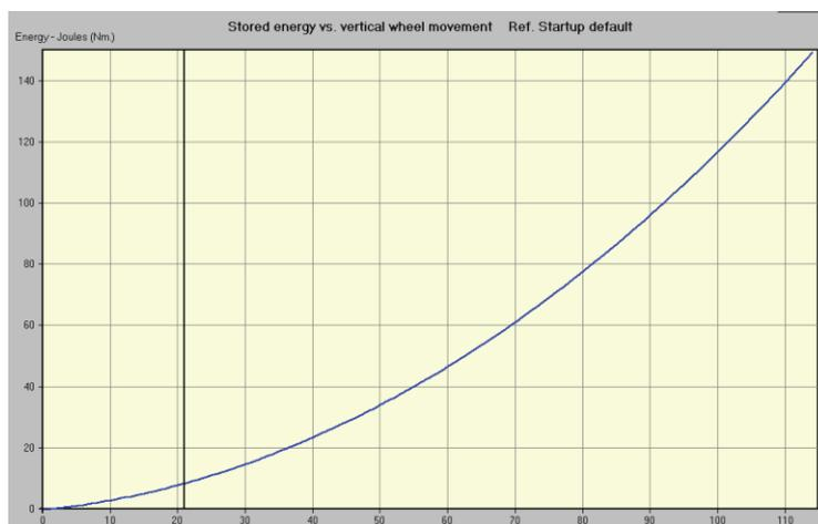
Gráfica 19. Energía almacenada en el amortiguador frente al desplazamiento vertical de la rueda
