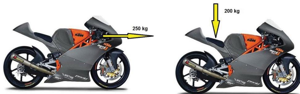
Ilustración 1. Casos de carga para la homologación del bastidor
