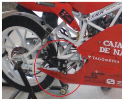
Ilustración 97. Ejemplo de posicionamiento de estriberas mediante un componente intermedio
