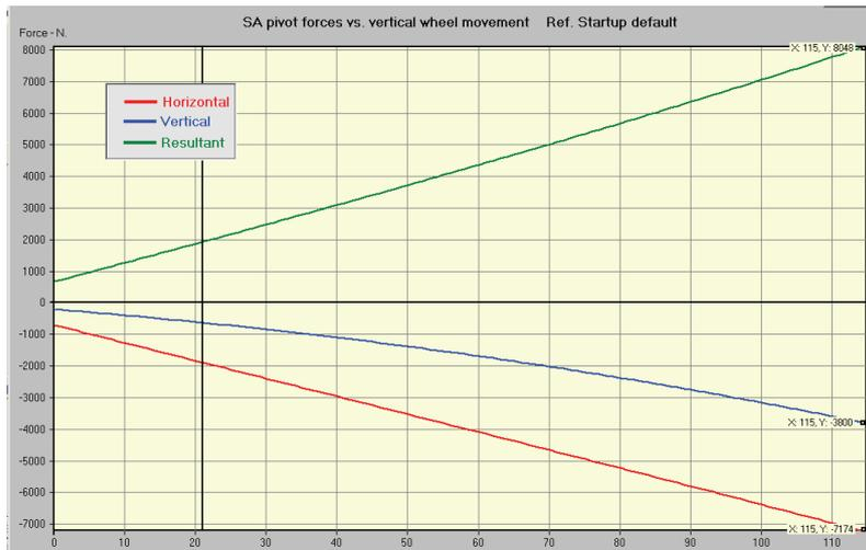
Gráfica 17. Fuerzas sobre el eje del basculante en función del desplazamiento vertical de la rueda
