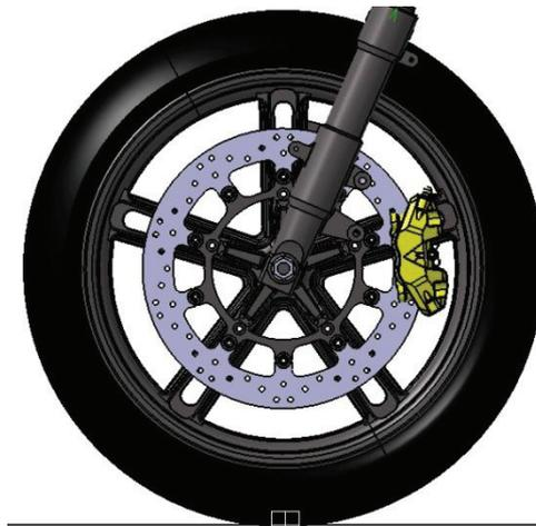
**Ilustración 106. Posicionamiento preliminar de los componentes del subsistema de freno delantero**
