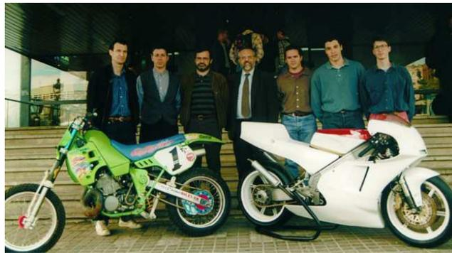
Figura 3.11. Imagen de la Kawasaki 500 con sistema Bilever, y de la aplicación de este mismo sistema a una moto de carretera.
