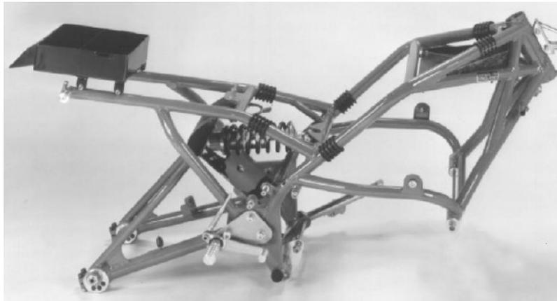
*Figura 8.8. Chasis multitubular.*
