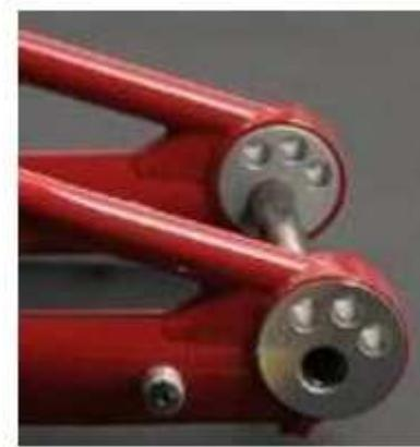
*Figura 10.18. Ejemplo de excéntricas utilizadas en el eje trasero.*
