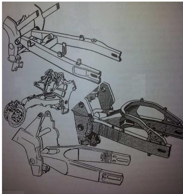
Figura II.4. Tipos más usuales de bastidores empleados en motocicletas. Se pueden apreciar modelos dobles, con refuerzos superiores, de tipo monobrazo y de sección variable.
