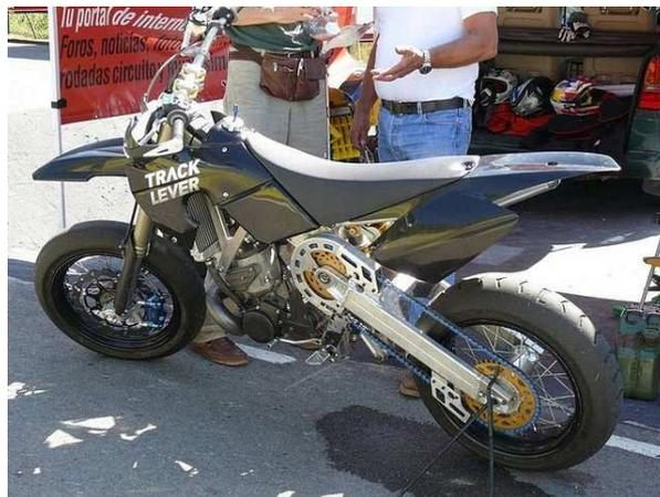
*Figura 2.1. Motocicleta dotada del sistema Tracklever.*
