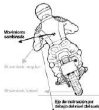
Figura 6.29. Al añadir los dos movimientos se produce un movimiento combinado con un radio más grande.
