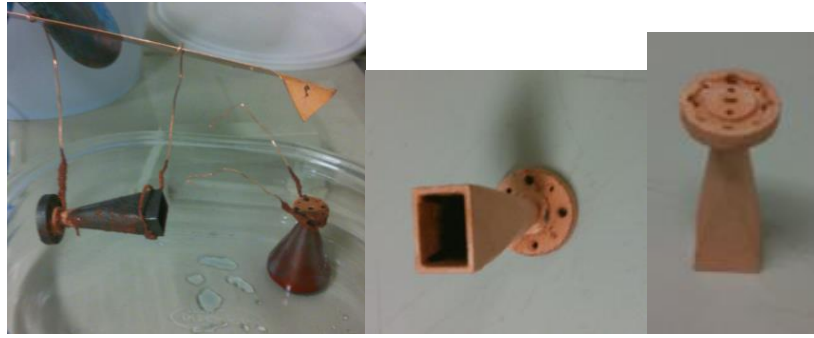
Figura 3.36 Metalización mediante proceso electrolítico
