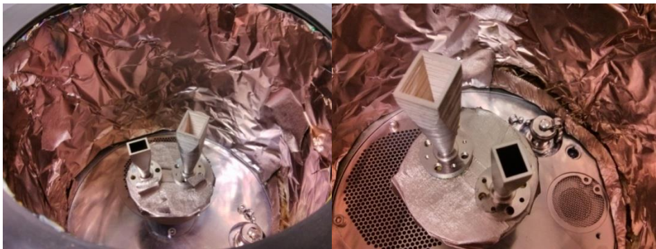
Figura 3.39 Metalización por Sputtering
