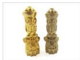
Figura 2.3 Prototipos en impresora 3D fabricados en latón con acabado dorado.
