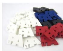
Figura 2.1. Prototipos en impresora 3D fabricados en poliamida.
