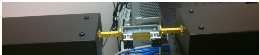
Figura 4.12 Medidas del acoplador con el analizador de redes y las cargas puntuales
