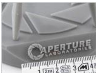
Figura 2.5 Prototipos en impresora 3D fabricados en prime gray.
