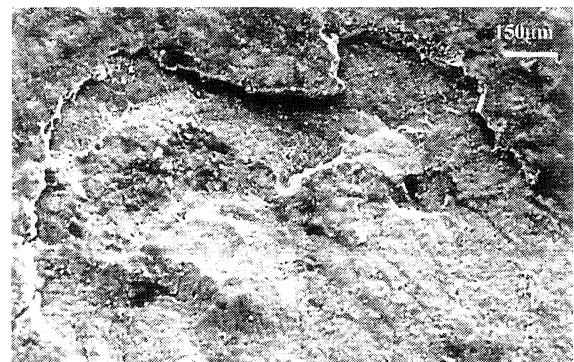
Figura 2. Micrografía, obtenida por Trueman et al. [69] , de una zona de material cerámico eliminada mediante termofractura.
