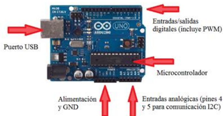
Figura 19. Elementos destacados del Arduino Uno. (Fuente: http://arduino.cc/en ).
