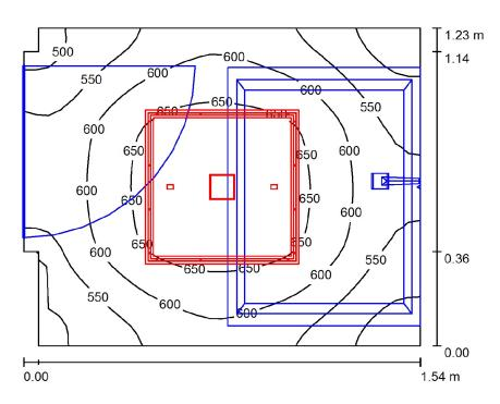
Altura del local: 2.800 m, Altura de montaje: 2.800 m, Factor
