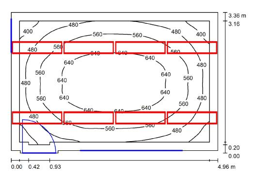
Altura del local: 2.800 m, Altura de montaje: 2.800 m, Factor
