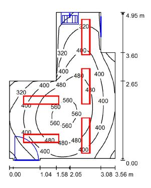
Altura del local: 2.800 m, Altura de montaje: 2.800 m, Factor
