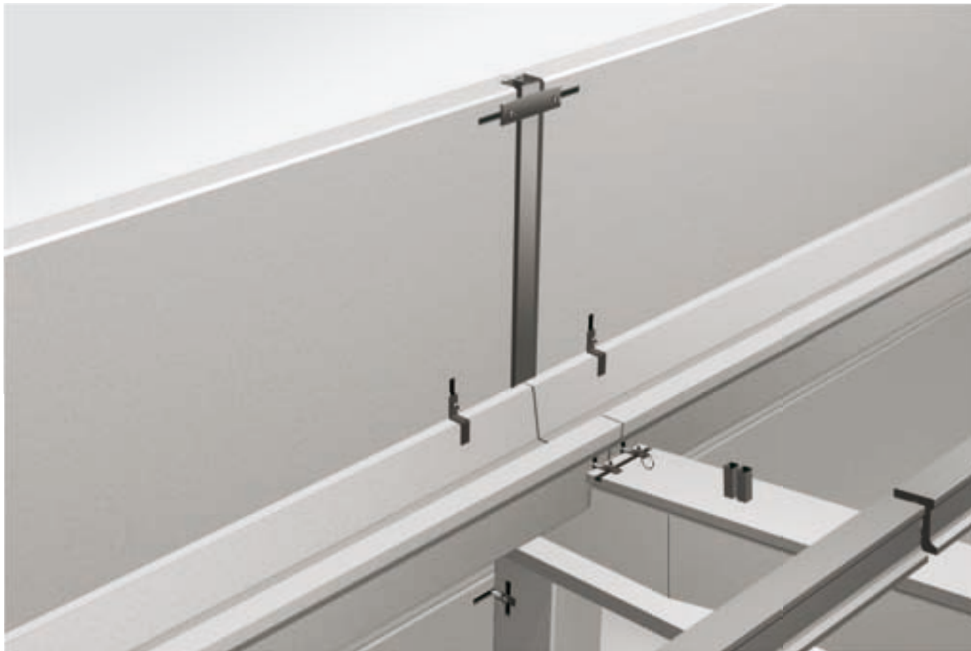
Unión paneles y cantonera a estructura en cara superior
