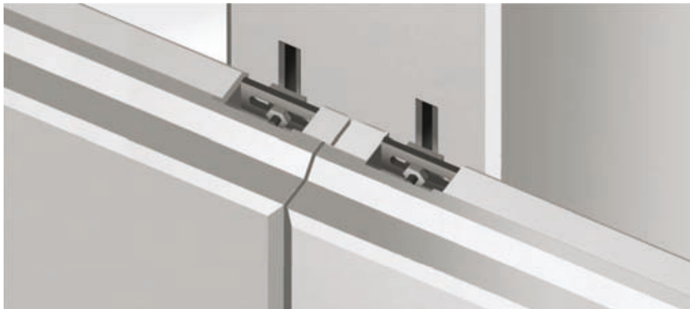
Apoyo panel en pilar con ménsula metálica
