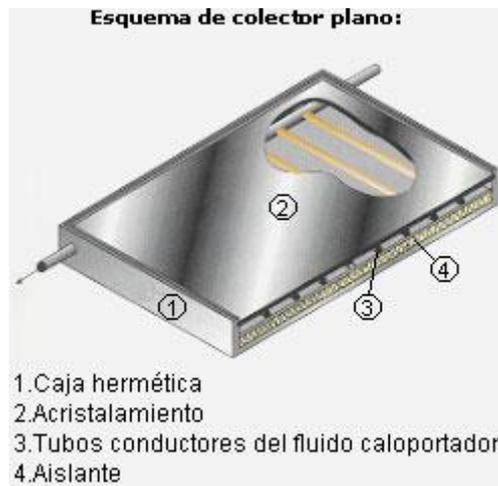
**Ilustración 17: esquema simple captador plano.**
