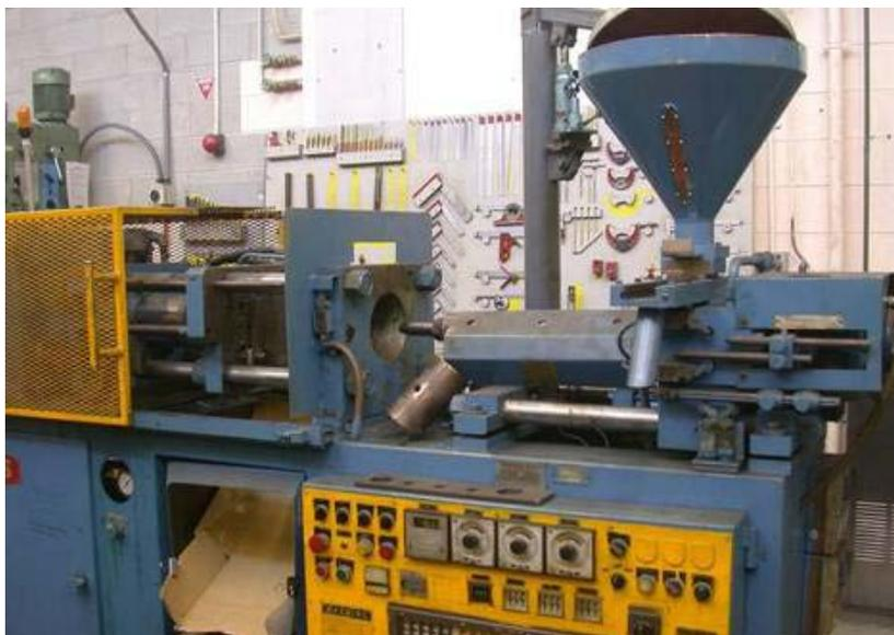
Figura 10 – *Máquina de inyección de plásticos*
