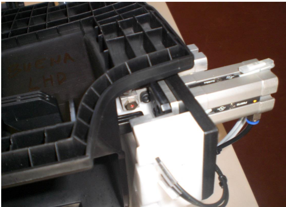
Figura 27: Micro pistón a punto de empujar el brazo
