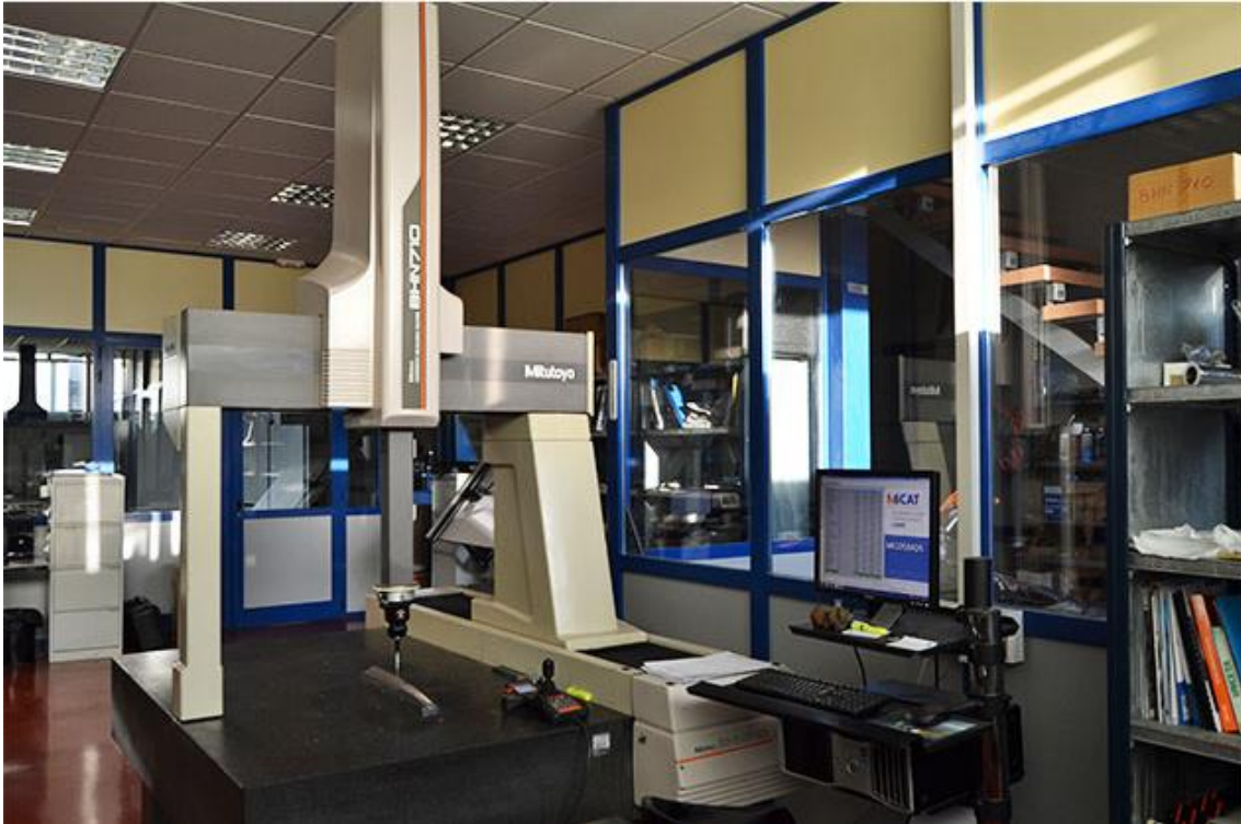
Figura 2: Máquina tridimensional de coordenadas BHN710
