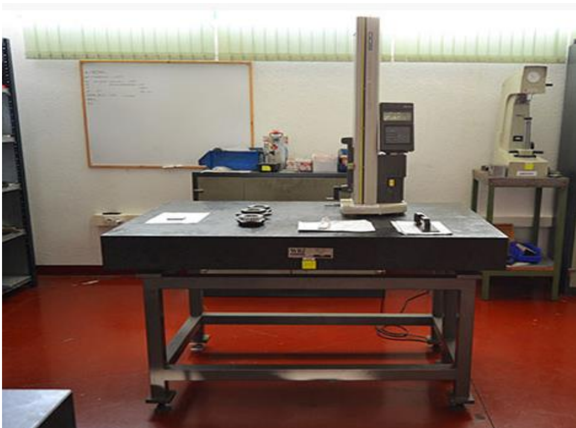
Figura 3: Torre de medición Mitutoyo linear height 600
