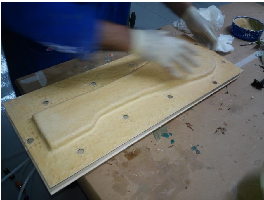
Se coloca en el bastidor, el cual se cierra y se atornilla.
