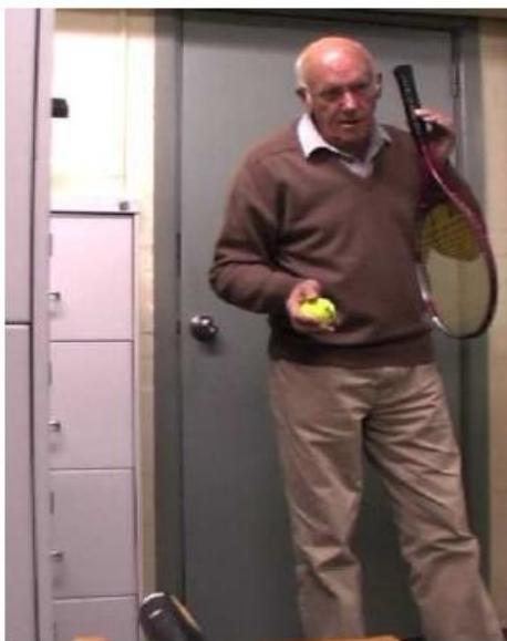
Fig.10.8.: Rod Cross sujeta una raqueta por la empuñadura con dos dedos mientras golpea con una bola la zona encordada para buscar el nodo de vibración.
