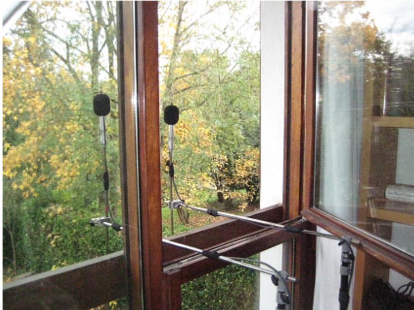
*Figura 2. Disposición de los micrófonos del equipo de medida*
