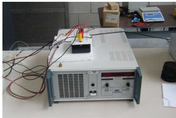
Figura 4.1-7 Fuente de alimentación. Encima de la fuente de alimentación se puede apreciar el montaje eléctrico que ha permitido la medida de tensión e intensidad (ver Figura 4.2-4).
