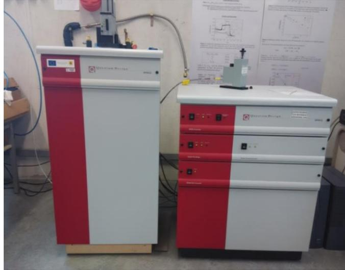
**Figura 2.12:** Magnetómetro SQUID Quantum Design MPMS XL-7. A la izquierda, el criostato. A la derecha, el controlador de temperatura.
