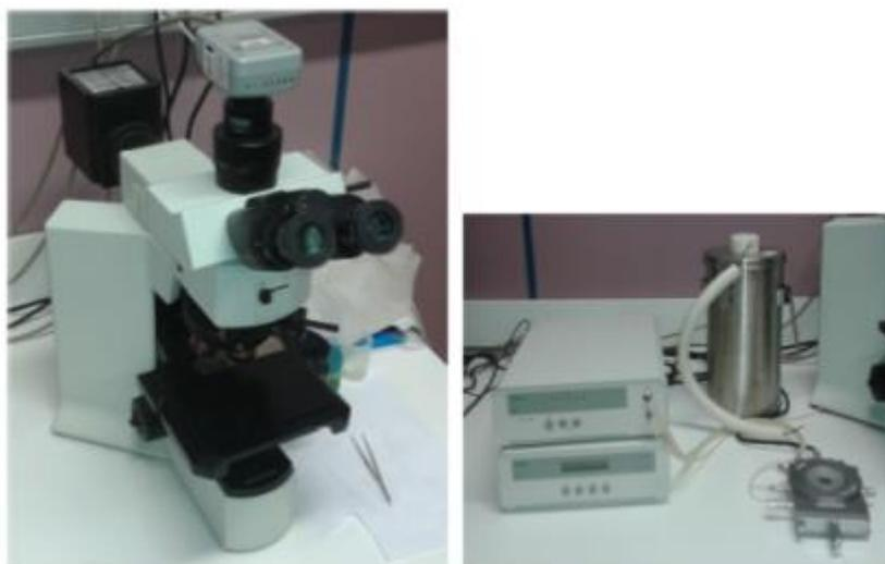
**Figura 2.4:** A la izquierda, microscopio óptico OLYMPUS BX15X. A la derecha, dispositivo Linkam THMS600 y equipo encargado de realizar el proceso de calentamiento-enfriamiento.
