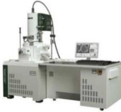
Figura 2.5: Microscopio electrónico de barrido JSM-5610LV del Servicio de Apoyo a la Investigación (S.A.I).
