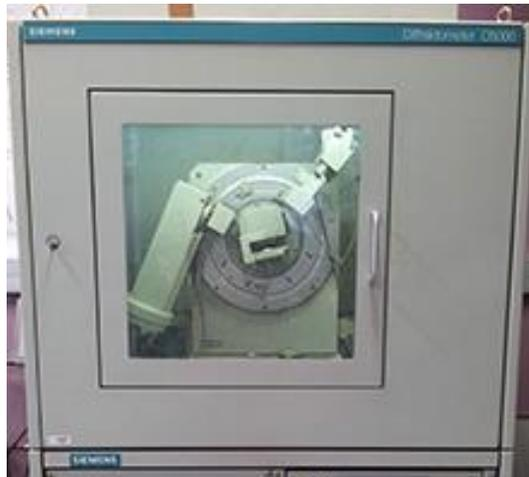
Figura 2.9: Imagen del difractómetro D5000 (Siemens).
