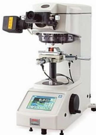
Figura 2.14: Microdurómetro "Mitutoyo microwizhard" utilizado en la caracterización de las propiedades mecánicas de las aleaciones elaboradas.
