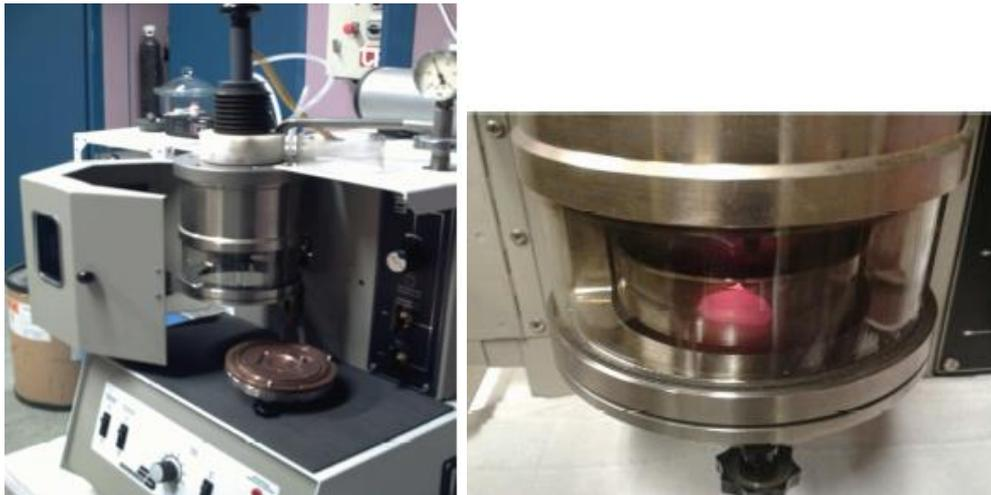
**Figura 2.2:** *A la izquierda, horno de arco empleado en la elaboración de la aleación. A la derecha, fotografía de la pastilla elaborada tras uno de los procesos de fusión.*
