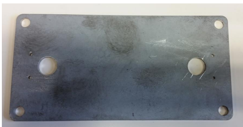
Figura 67: Pieza base de chapa de acero, obtenida por corte laser
