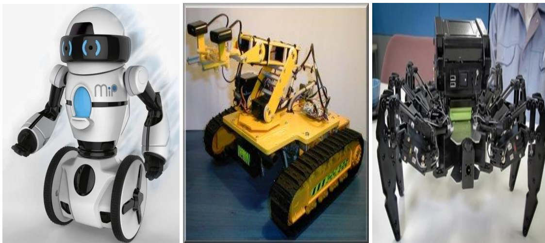
Figura 1: Locomoción por ruedas(a); por orugas (b); por patas (c) - fuentes: http://www.damngeeky.com/wp-content/uploads/2013/12/MiP-robot-by-WowWee.jpg ; https://sites.google.com/site/irenerobotica/6-robots-moviles
