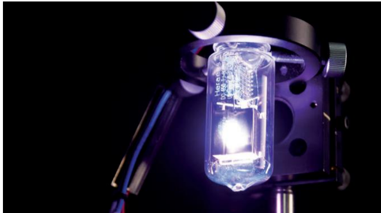
ILUSTRACIÓN 5: BOMBILLA DE DEUTERIO SITUADA EN EL INTERIOR DE LA FUENTE AVALIGHT-DHC
