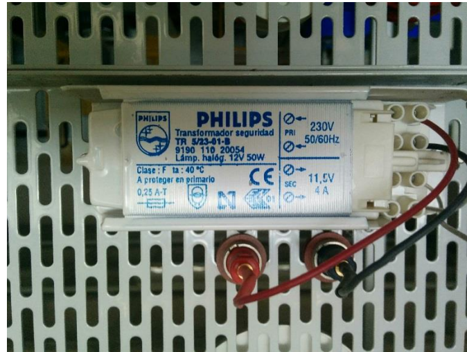
ILUSTRACIÓN 18: FUENTE DE ALIMENTACIÓN CONMUTADA INTERNA (ALIMENTACIÓN DE BOMBILLAS HALÓGENAS PANELES DOMÓTICOS UPNA)
