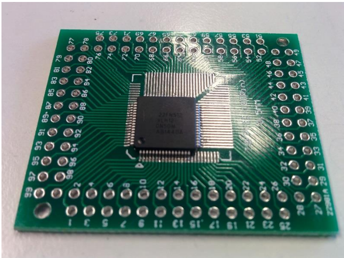
ILUSTRACIÓN 51: MICROCONTROLADOR EN PLACA COMERCIAL DE 100 PINES
