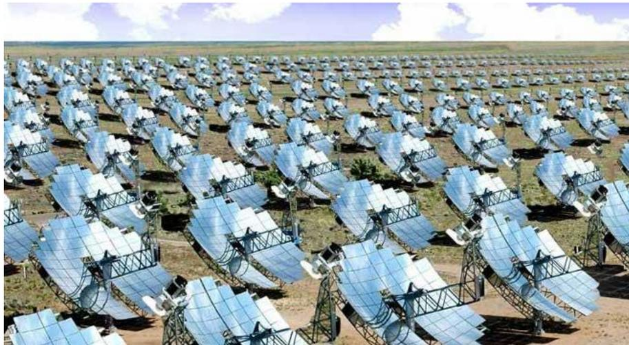
*Ilustración 12: Discos parabólicos*
