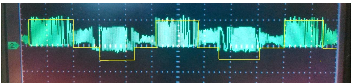
Figura 35. Fuerza contra electromotriz del motor con respecto a la forma de onda del puente en H.
