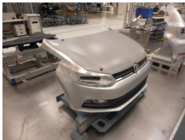
Ilustración 32. Semiesferas rojas para definir los RPS
