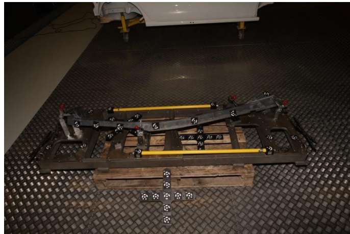
Ilustración 41. Targets, codificados y barras de escala
