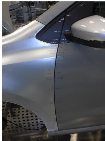
Ilustración 72. Desviación de puntos en Meisterbock
