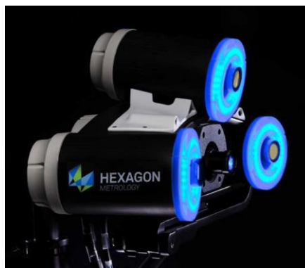
Ilustración 19. Sensor y cámaras digitales del Hexagon Metrology de luz blanca
