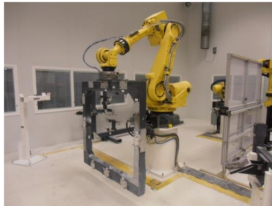
Ilustración 21. Robot de soporte de piezas de medición de la WLS400M
