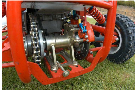
Fig.11. Freno trasero Car Cross con doble pinza. Fuente: http://kart-cross.tripod.com
