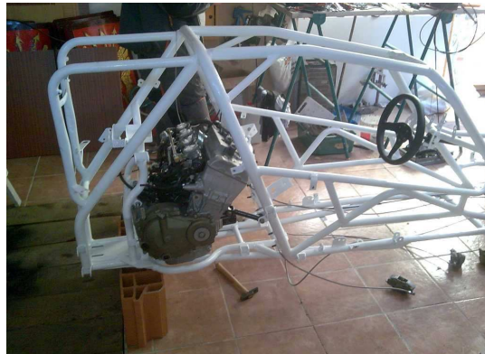
Fig.8. Motor de moto sobre Car Cross. Fuente: http://www.mercadoracing.org
