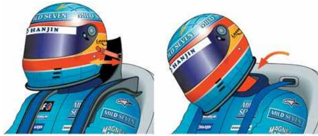
Fig.19. Funcionamiento del sistema HANS.
