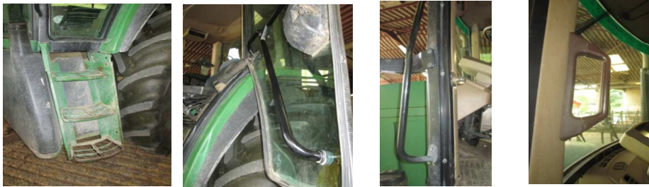
Peldaños de acceso a cabina y puntos de agarre en buen estado.
