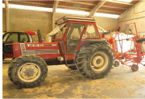
Cabina de protección.
