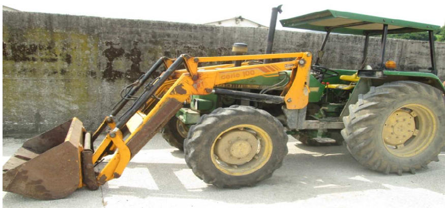
Cabina de protección antivuelco sin cerrar.
