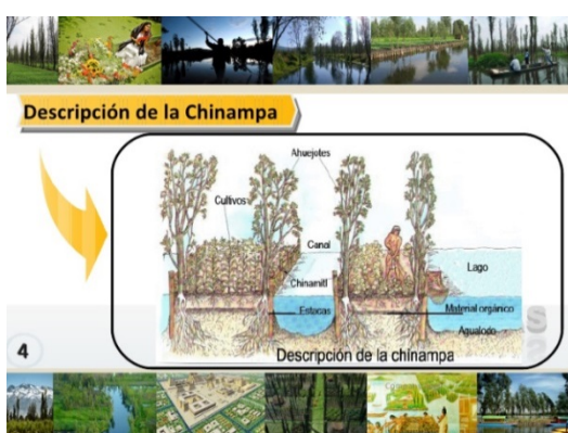
Figuras 16: Descripción de la chinampa y los pasos a seguir para su construcción. Fuente: "Expo chinampas", 2010.
